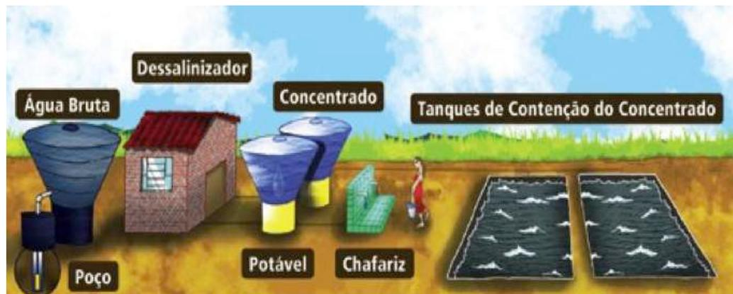
Figura 16: Esquema do processo de tratamento da água subterrânea
