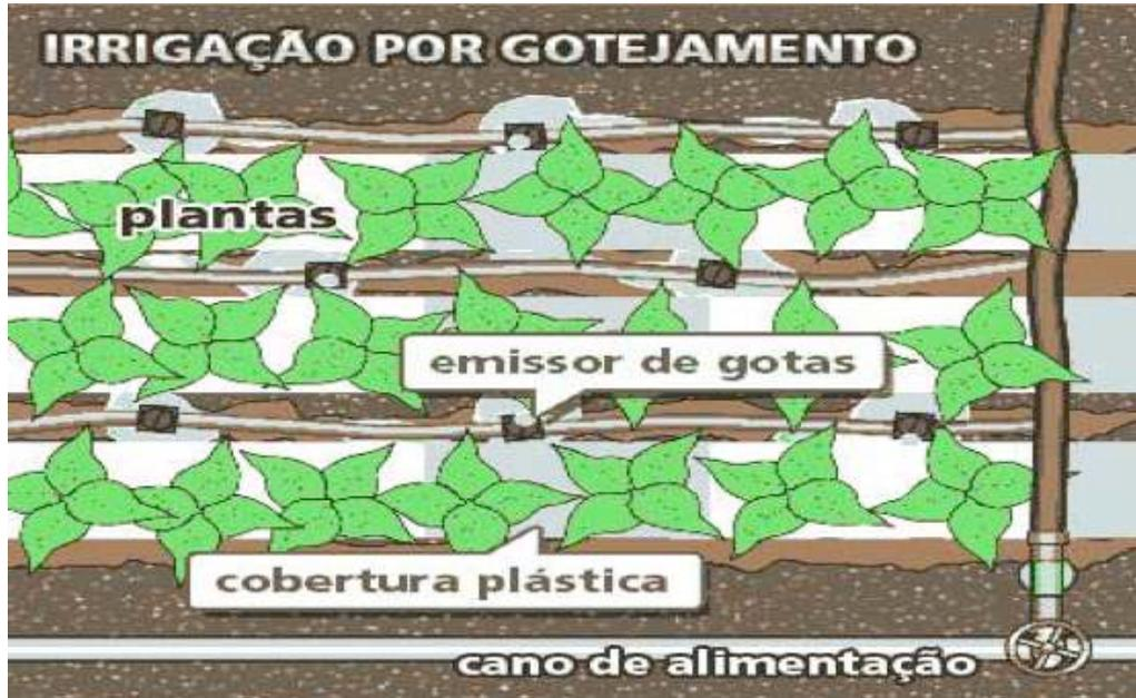
Figuras 18: Sistema de irrigação por gotejamento
