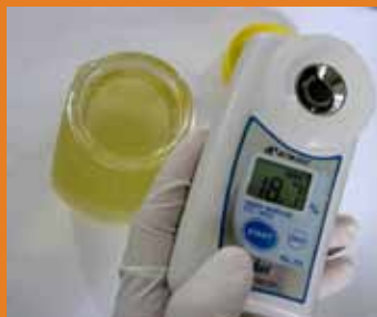
Detalhe do refratômetro indicando a umidade do mel antes da desumidificação (esq.) e depois (dir.)
