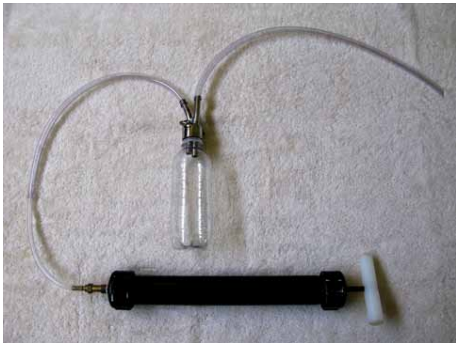
Exemplo de bomba de sucção manual acoplada a um recipiente de coleta PET/500 ml
