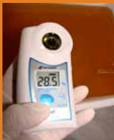
Detalhe do refratômetro indicando a umidade do mel antes da desumidificação (esq.) e depois (dir.)
