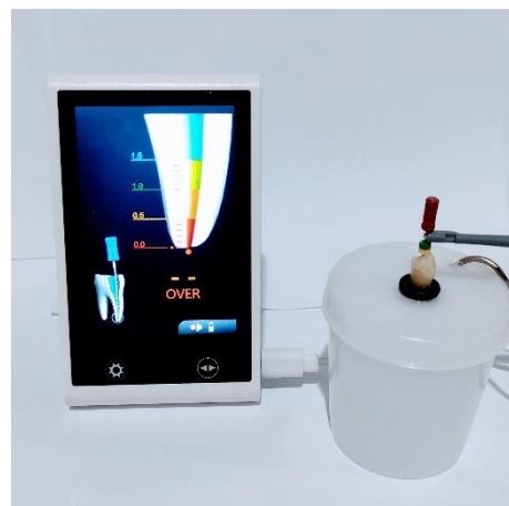
Figura 9. Momento da medição com o IRoot Apex. Fonte: próprio autor.
