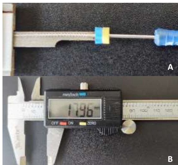
Figura 11. Medição do instrumento para obtenção do CRC (A), com paquímetro digital com precisão de \pm 0,01 mm (B).
