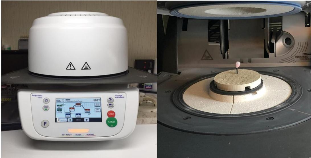
**FIGURA 10.** Forno de cocção de cerâmica. Ivoclar vivadent, programat P310
