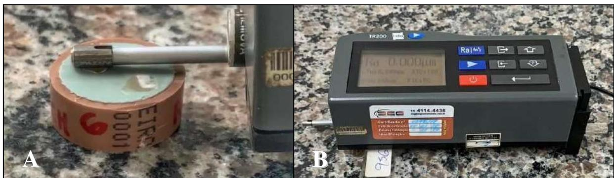
FIG. 11 - (A) Aparelho perfilômetro digital (Digimess, Brasil) utilizado no estudo. (B) Perfilometria dos corpos de prova. Fonte: Autores, 2019.
