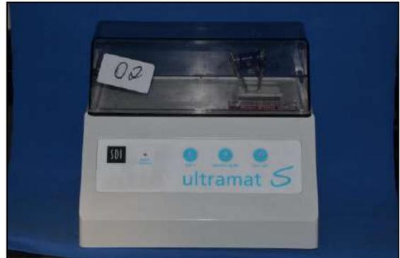
FIG. 7 – Amalgamador Ultramat S (SDI) com cápsula de CIV no momento da mistura por 10 seg
