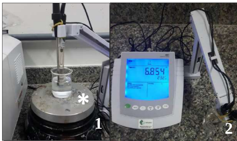
FIG 3. Dispositivos utilizados para medição do pH das amostras. Em (1), braço com eletrodo do pHmetro e agitador magnético (*). E em (2), a base do aparelho, responsável leitura. Fonte: Autores, 2019
