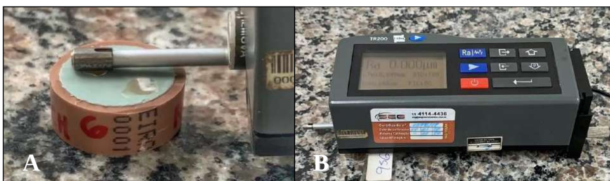
FIG. 11 - (A) Aparelho perfilômetro digital (Digimess, Brasil) utilizado no estudo. (B) Perfilometria dos corpos de prova. Fonte: Autores, 2019.
