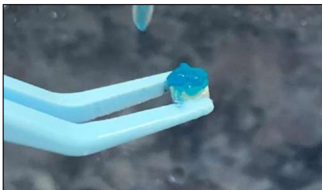
FIG. 9 – Condicionamento ácido do corpo de prova. Fonte: Autores, 2019.
