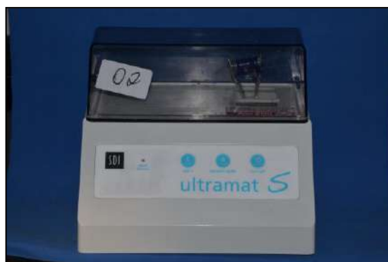
FIG. 7 – Amalgamador Ultramat S (SDI) com cápsula de CIV no momento da mistura por 10 seg
