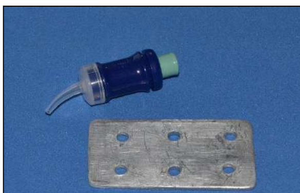
FIG. 6 – Cápsula de CIV Self Cure e matriz metálica com perfurações cilíndricas 4 x 2 mm. Fonte: Autores, 2019
