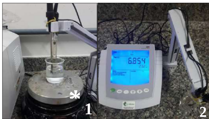
FIG. 3 – Dispositivos utilizados para medição do pH das amostras. Em (1), braço com eletrodo do pHmetro e agitador magnético (*). E em (2), a base do aparelho responsável leitura. Fonte: Autores, 2019
