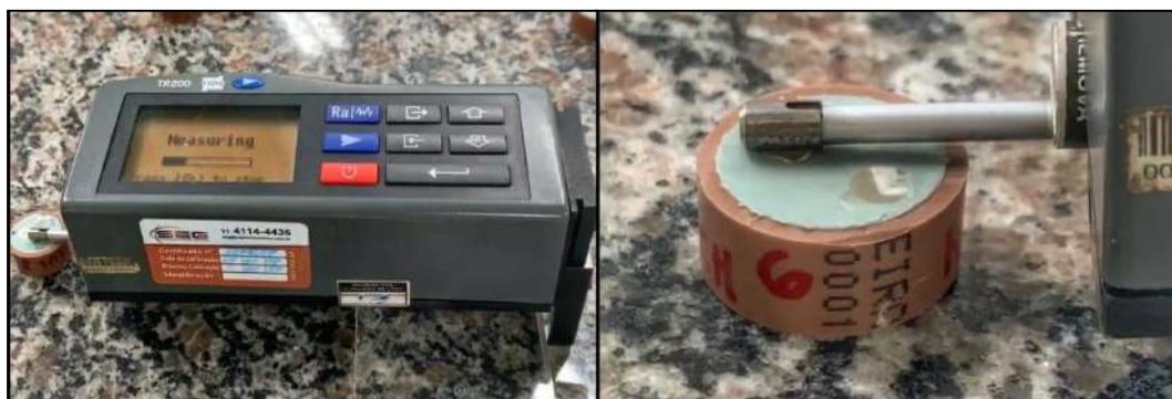
FIG. 9 – Análise da rugosidade superficial do CIV Riva Self Cure pós condicionamento ácido por 15 seg. Fonte: Autores, 2019
