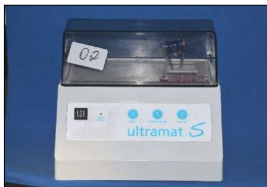
FIG. 7 – Amalgamador Ultramat S (SDI) com cápsula de CIV no momento da mistura por 10 seg. Fonte: Autores, 2019
