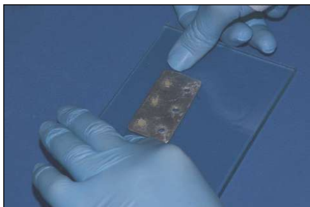
FIG. 8 – Confeção dos corpos de provas com tira de poliéster posicionada na superfície. O tempo de presa é de 6 minutos, de acordo com o fabricante. Fonte: Autores, 2019
