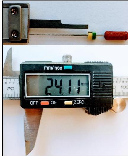
**FIGURA 3** – Momento da medição do instrumento endodôntico
