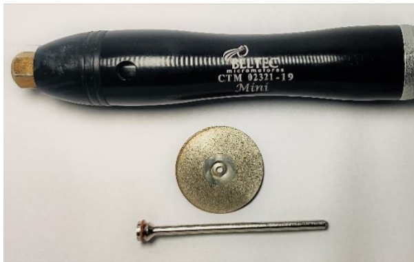
Figura 2. Motor elétrico, disco de corte e mandril.
