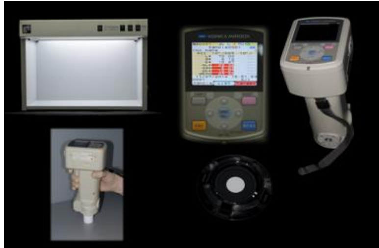
FIGURA 8. Materiais para análise de cor (Espectrofotômetro Konica Minolta CM-700d).
