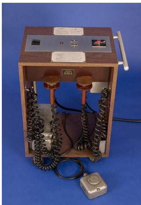
Figura 14. Desfibrilador constituído por caixa portátil com dois cabos isolados e eletrodos de cobre. Juazeiro do Norte, Ceará, Brasil. 2024. Fonte: Museu EMS., [s. d].
